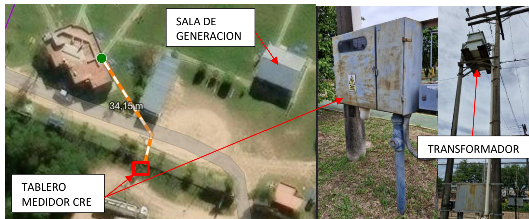
Figura 3. Tablero de medidor de la red pública de CRE
