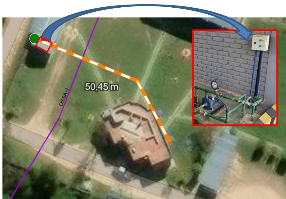
Figura 20. Bomba de llenado de refrigerante a radiador de unidades (UBPs)
